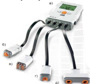
Рисунок 1. а). Микрокомпьютер. б). Датчик касания. в). Датчик звука. г). Датчик освещённости. д). Датчик расстояния.
