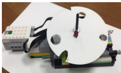
Рисунок 2. Фотография модели привода оптических дисков, выполненная с помощью робототехнического набора Lego WeDo 2.0.
