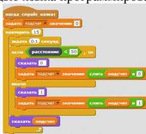
Рисунок 4. Блочный код Scratch, реализующий работу привода оптических дисков
